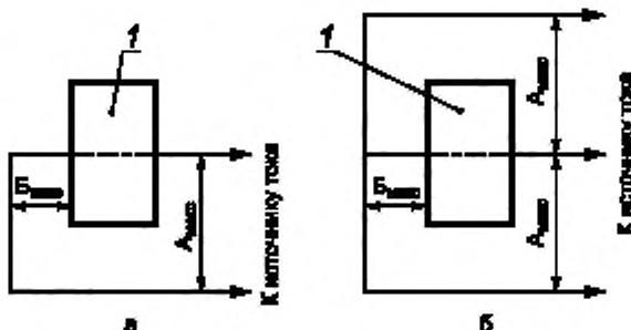
1 — испытуемый трансформатор;  $A_{\max}$  — расстояние между осями проводников соседних фаз в месте установки трансформатора в эксплуатации,  $B_{\max}$  — расстояние в свету от трансформатора до места ближайшего изгиба проводника, спущающегося в эксплуатации первичной обмоткой трансформатора
