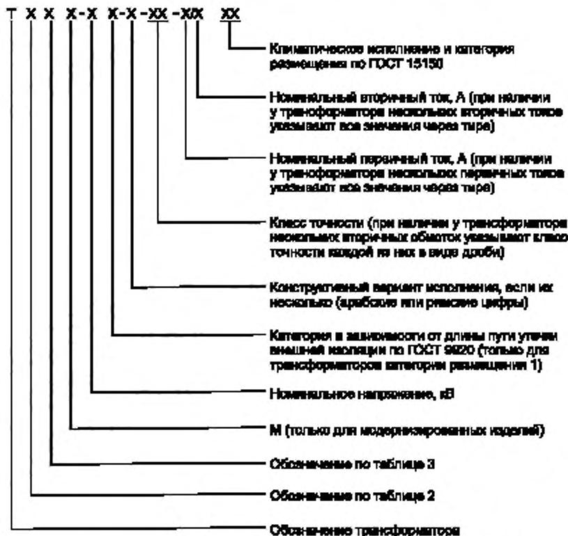
Примечание 1 — В документации на трансформаторы конкретных типов в обозначении допускается применять дополнительные или исключать отдельные данные для обозначения особенностей конкретного трансформатора.
