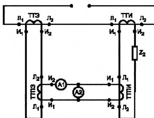
ТТЭ — эталонный трансформатор тока; ТТИ — испытуемый трансформатор тока;
