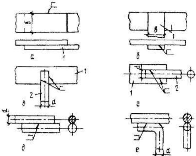
**Рис. 8.7. Соединение заземляющих проводников с горизонтальными заземлителями:**
