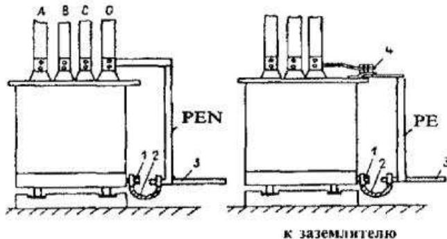
**Рис. 10.1. Заземление силового трансформатора с заземленной нейтралью вторичной обмотки напряжением до 1000 В (а) и с изолированной нейтралью (б)**
