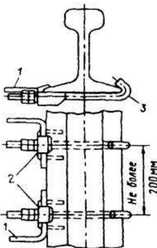
**Рис. 8.3. Присоединение к тяговому рельсу проводников защитного заземления:**
