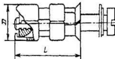
**Рис. 7.2. Дюбель с распорной гайкой**
