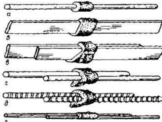
**Рис. 8.9. Соединение стальных полос и стержней, выполненные термитной сваркой**
