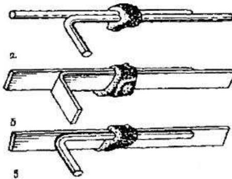
**Рис. 8.10. Ответвления стальных заземляющих проводников, выполненные термитной сваркой**
