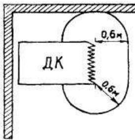
**Рис. 10.9.С. Расположение душевой кабине (ДК), изготовленной заводским способом**
