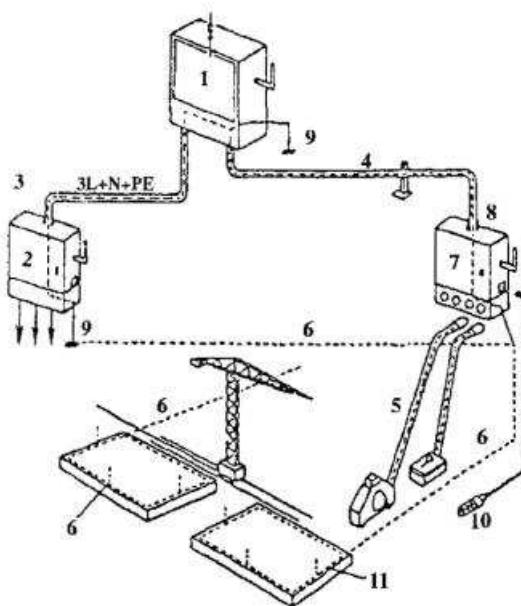
**Рис. 10.6. Электроустановка, питающая строительную площадку средних размеров**
