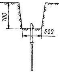
**Рис. 8.4. Установка вертикальных заземлителей**
