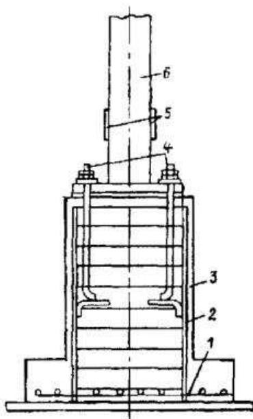
**Рис. 8.2. Соединение металлической колонны с арматурой железобетонного фундамента:**
