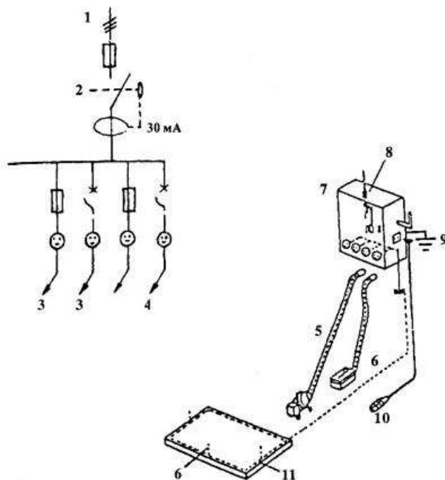
**Рис. 10.5. Электроустановка, питающая строительную площадку небольших размеров**
