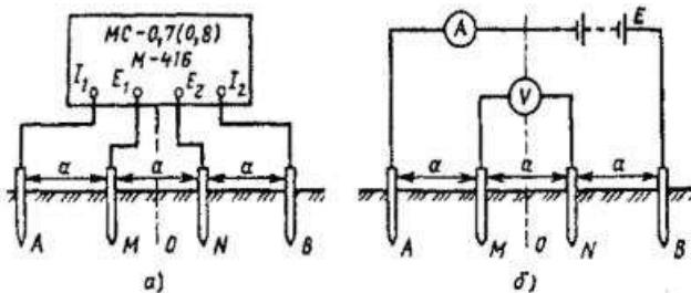
**Рис. 11.1. Схема для определения удельного сопротивления грунта:**
