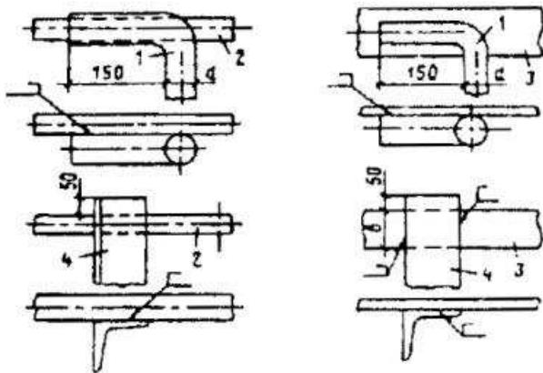
**Рис. 8.6. Соединение заземляющих проводников с вертикальными заземлителями:**
