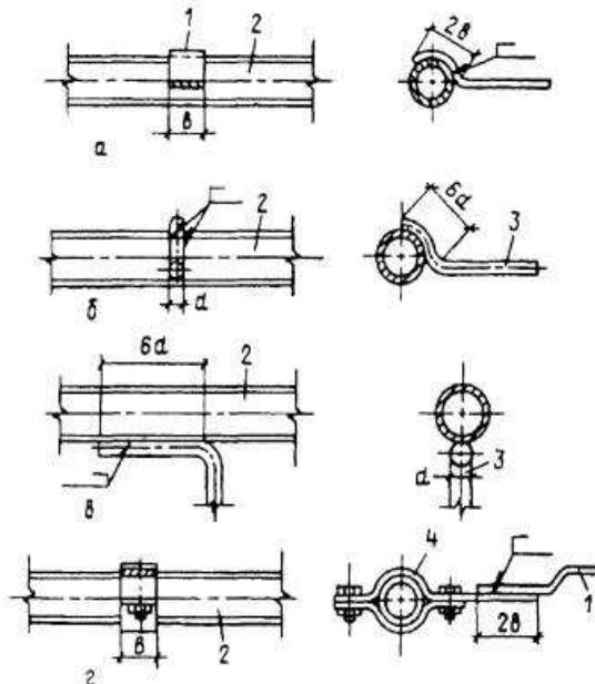
Рис. 8.8. Присоединение заземляющего проводника к трубопроводу сваркой (*a* - *e*) и с помощью хомута (*f*):
