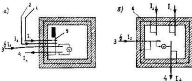
**Рис. 2.1.7. Схемы ввода в здание металлических подземных коммуникаций:**
