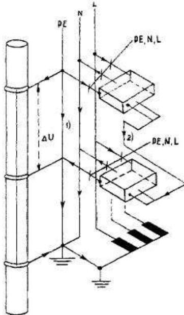
**Рис. 2.1.6. Система питания электроустановок многоэтажного здания TN-S**
