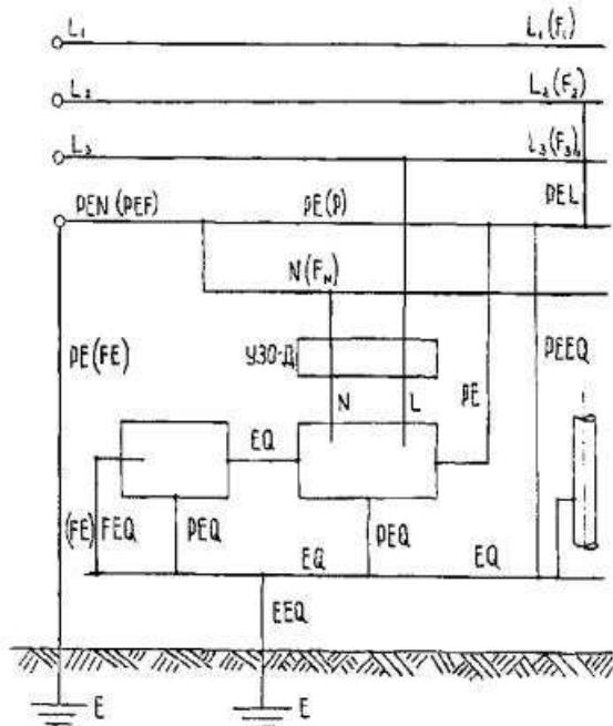
**Рис. 2.2.2. Защитное и рабочее заземления в системе TN.**
