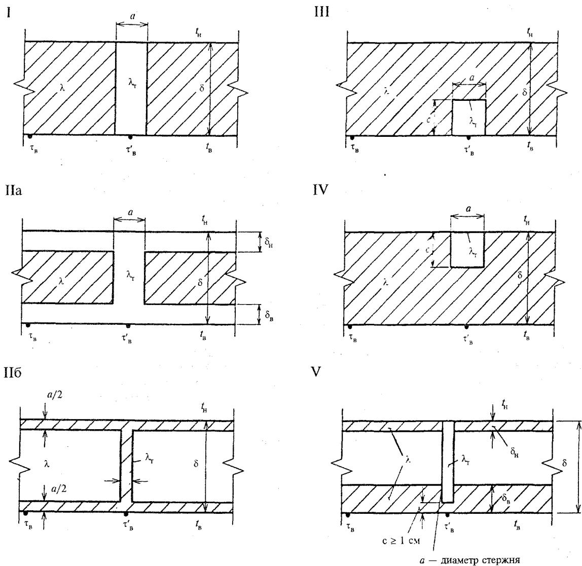
Рисунок 1 Схемы теплопроводных включений в ограждающих конструкциях
