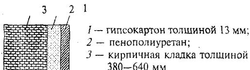
**Кирпичная стена, утепленная напылением
