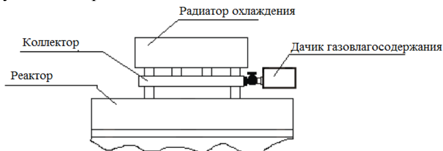
Приложение А Рисунок 1. Место установки датчиков газовлагосодержания на объединительном коллекторе радиаторов охлаждения
