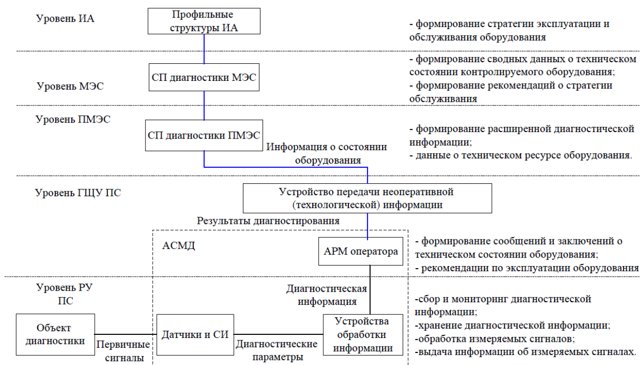
Рис. 2. Схема передачи диагностической информации по уровням управления
