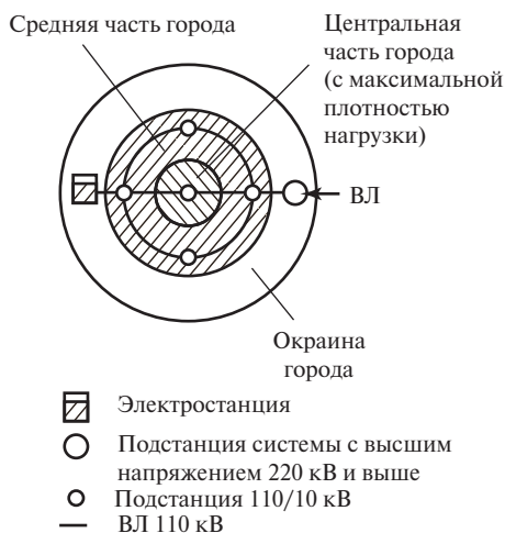
Рис. 4.19. «Идеальная» схема электроснабжения города
