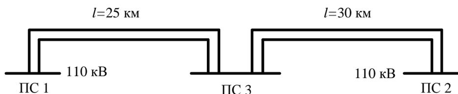
Рис. Е.1 – Схема присоединения ПС 3 (вариант 1)
