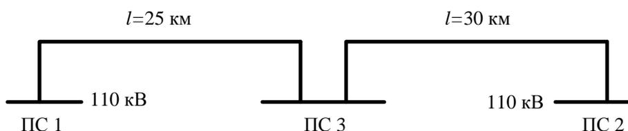
Рис. Е.2. Схема присоединения ПС 3 (вариант 2)
