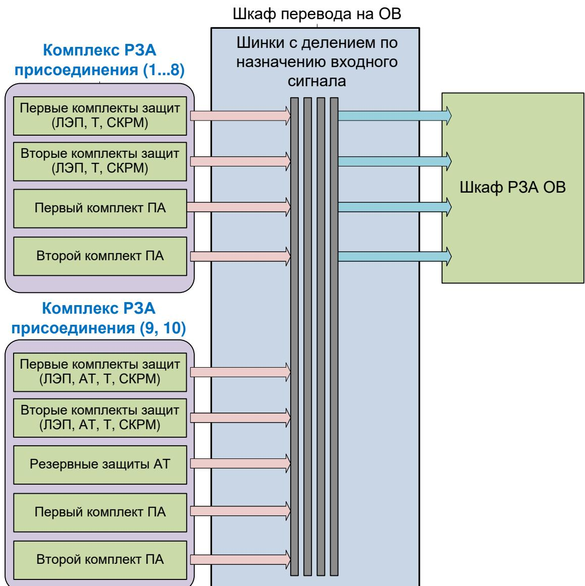
Рисунок 15.1.2 - Поясняющая схема организации входных цепей РЗА ОВ
