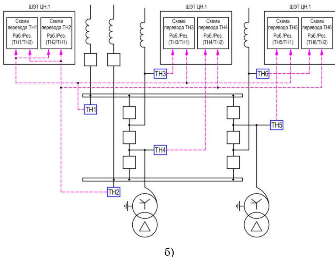
Рисунок А.9 - Поясняющая схема организации ЦН для схем РУ 110-9АН, 220-9АН с трансформатором (а), с автотрансформатором (б)
