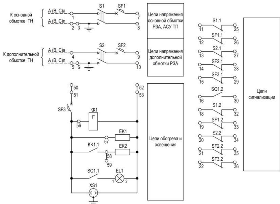
Рисунок 12.2.2 - Схема электрическая принципиальная ШЭТ ТН.1
