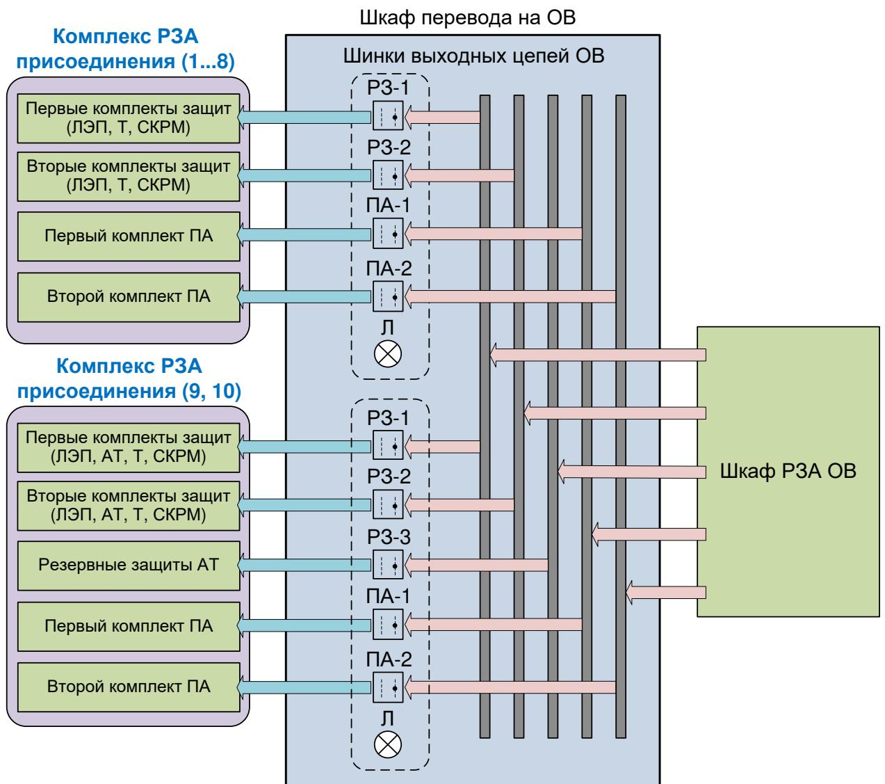
Рисунок 15.1.3 - Поясняющая схема организации выходных цепей РЗА ОВ
