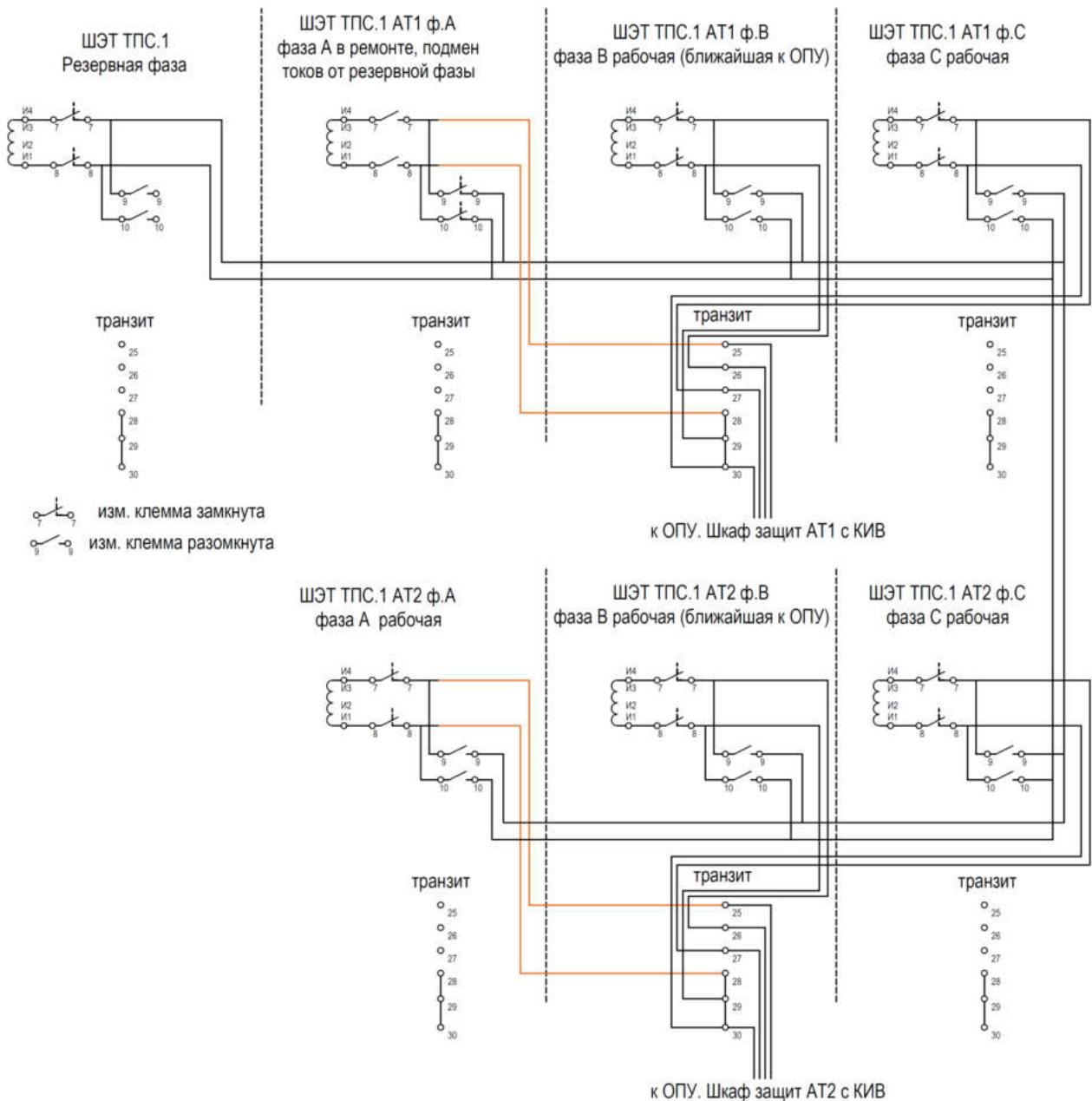
Рисунок 13.2.3 - Организация контроля изоляции высоковольтного ввода резервной фазы
