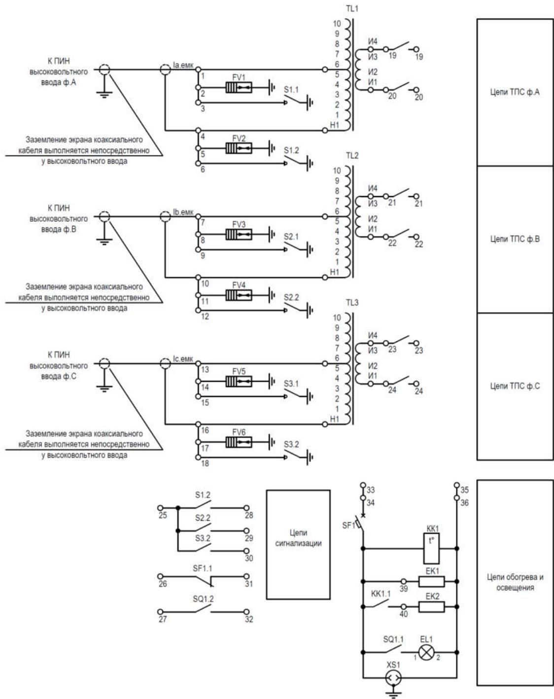
Рисунок 13.3.2 - Схема электрическая принципиальная ШЭТ ТПС.3
