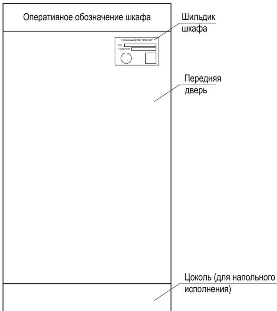
Рисунок 8.6.1 - Общий вид спереди шкафа ВК наружной установки
