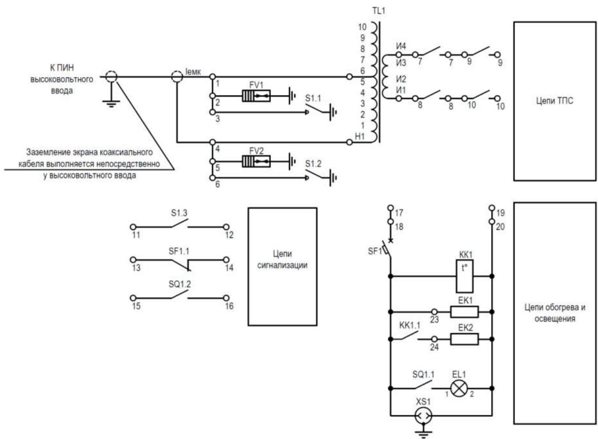
Рисунок 13.2.2 - Схема электрическая принципиальная ШЭТ ТПС.1
