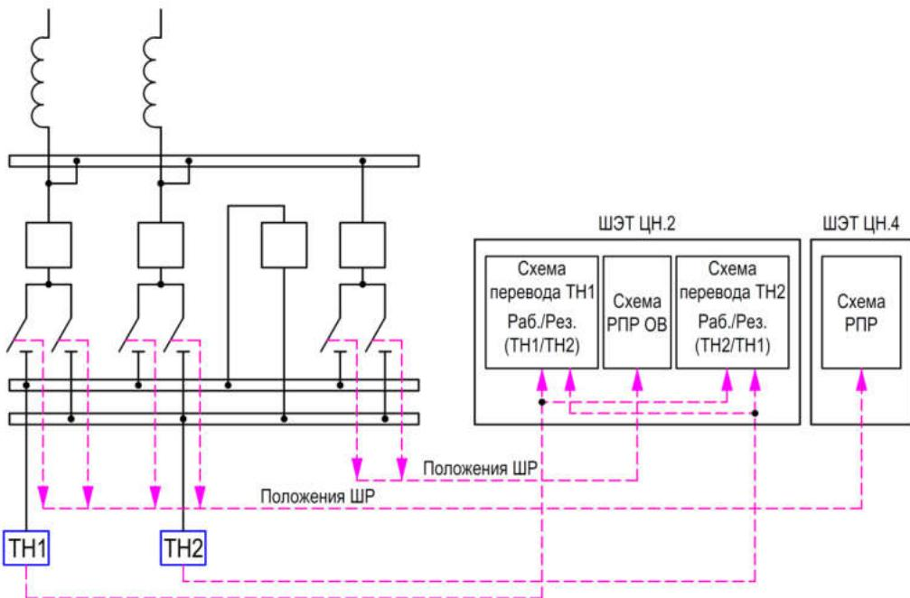
Рисунок А.13 - Поясняющая схема организации ЦН для схем РУ 110-13H, 220-13H
