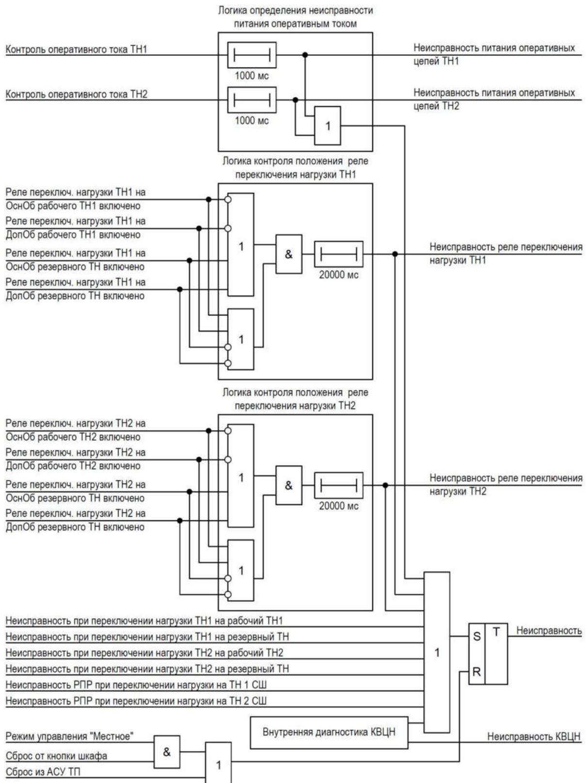
Рисунок 14.2.6 - Обобщенная функциональная схема логики контроля неисправности КВЦН для ЩЭТ ЦН.2-1
