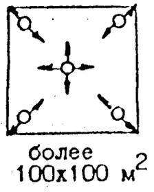
Рис. 4.1. Расположение центров зондирования и направления полуразносов установок ВЭЗ
