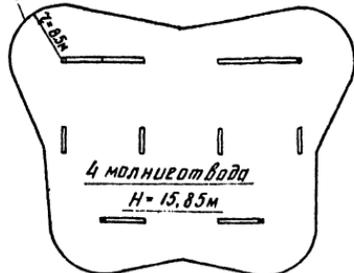
Зона защиты на высоте  $h = 7.85 \text{ м}$ .
